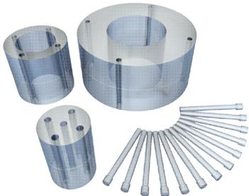
一组同质圆柱，设计用于小儿和成人头部及身体成像，可用于CTDI测量和散射测量。磨砂PMMA材料的密度为1.19 g/cm<sup>3</sup>。该模体代替之前的76-424-4156型模体。随模体提供重型风暴防护仪器箱，可容纳带有R/F和CT传感器的X2。
